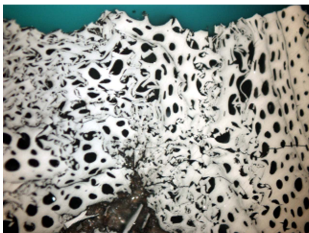
Rys. 3a. Grupa inertynitu – fuzynit o pustych, dobrze zachowanych owalnych komórkach. Immersja, pow. 500×
