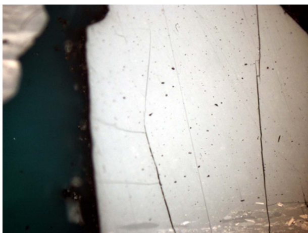
Rys. 1a. Grupa witrynit – kolotelinit (dawniej kolinit). Macerał, w którym brak jest wyraźnej budowy komórkowej. Na jego nieodmienionej – czystej powierzchni określany jest stopień refleksyjności. Immersja, pow. 500 \times
