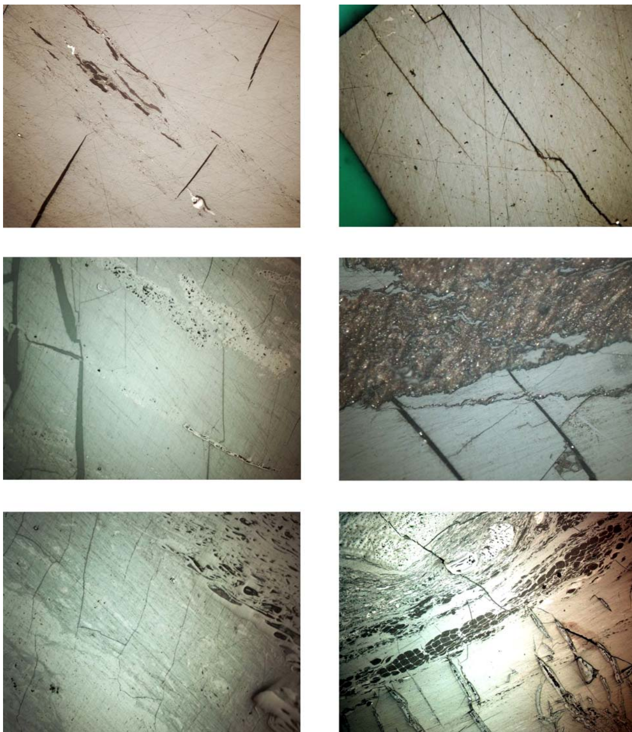
Rys. 3. Spękania o charakterze pierwotnym – endogenicznym. Próbkę węgla pobrano z KWK Borynia-Zofiówka pokład 406/1, KWK Pniówek pokład 403/3. Pow. 500×, światło odbite, immersja
