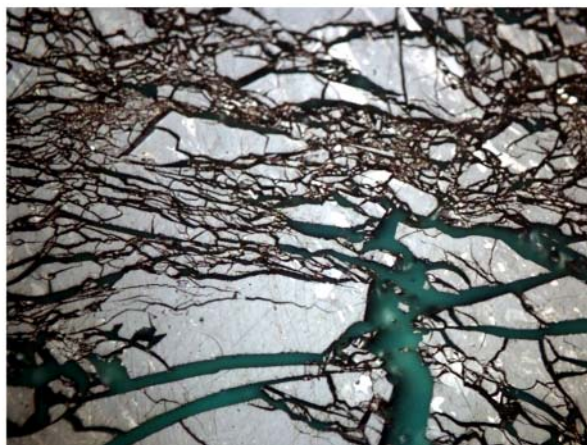
Rys. 6. Węgiel kataklastyczny – mezokataklaza. Próbkę węgla pobrano z KWK Borynia-Zofiówka pokład 406/1, KWK Pniówek pokład 403/3, KWK Brzeszcze pokład 352 Zachód, Pow. 500×, światło odbite, immersja
