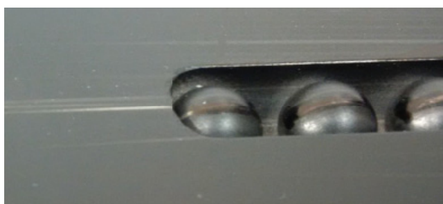
Rys. 7. Zniszczenie warstwy antyrefleksyjnej na pierwszych rzędach kulek
