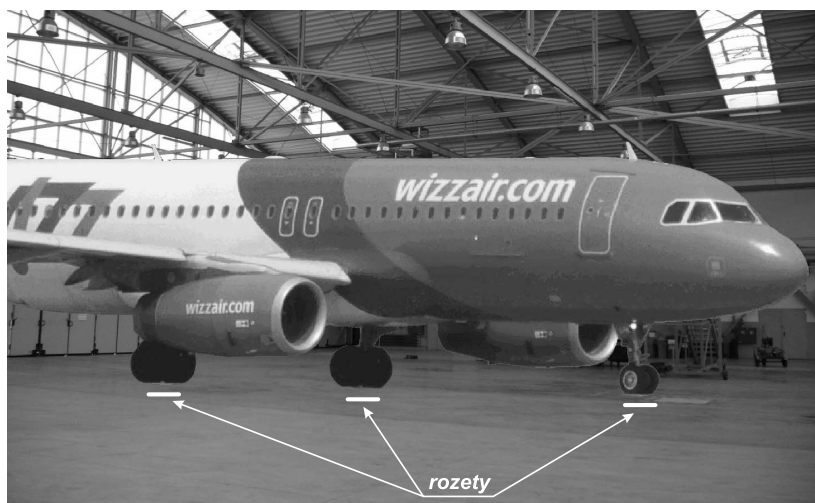
Rys. 1. Planowany montaż rozet pomiarowych w posadzce hangaru. Rozeta pod podwoziem głównym prawym nie jest uwidocznioma (fotomontaż ze zdjęć autora, samoloty prawie zawsze serwisowane są w nocy)
