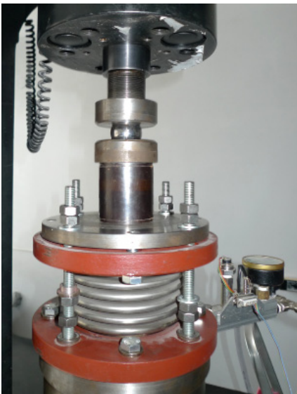
Rys. 3. Próbka podczas testu jednoosiowego ściskania w komorze do nasączania płynem porowym pod ciśnieniem
