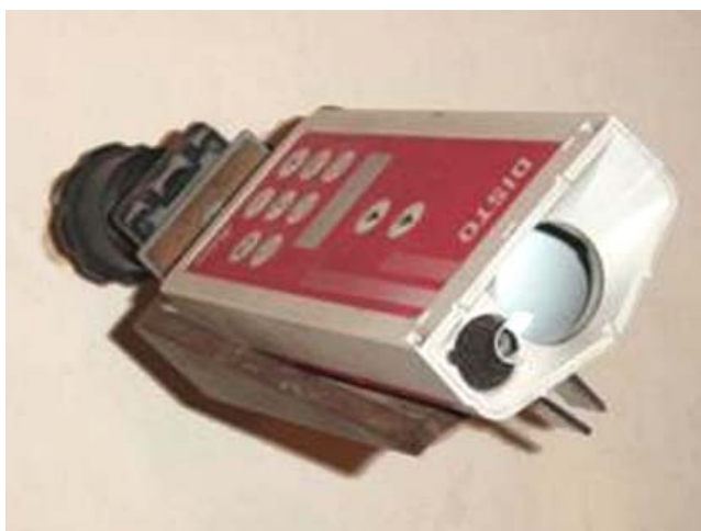
Rys. 5. Dalmierz laserowy i tarcza celownicza przymocowane do specjalnie zastabilizowanych znaków pomiarowych (www.chemkop.pl)
