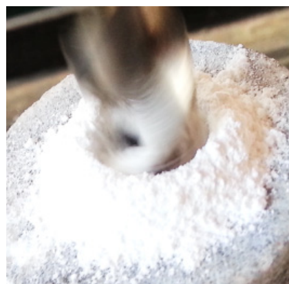
Rys. 4. Przykładowa próbka anhydrytu w trakcie rozdrabniania metodą wiercenia
