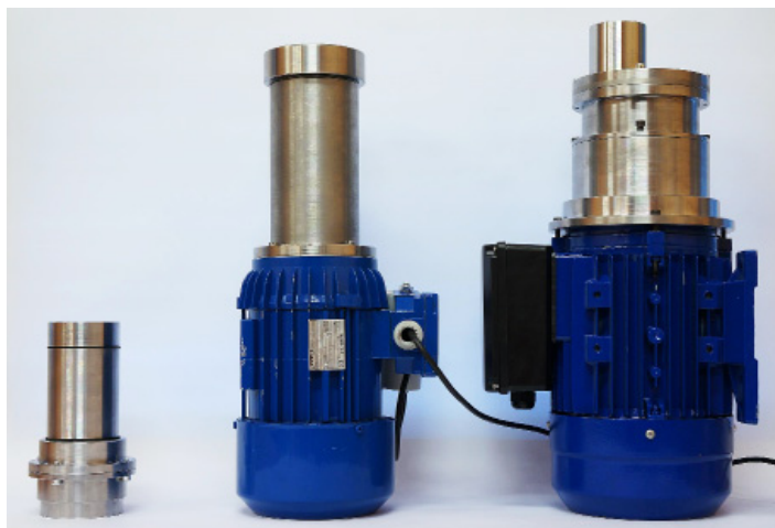
Rys. 2. Zdjęcie trzech urządzeń do rozdrabniania skał (kolejno od lewej: urządzenie mielące, urządzenie wierzące, urządzenie ścierające)
