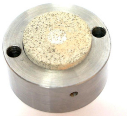
Rys. 3. Przykładowa próbka skały miedzionośnej umieszczona w zbiorniku na próbkę urządzenia rozdrabniającego
