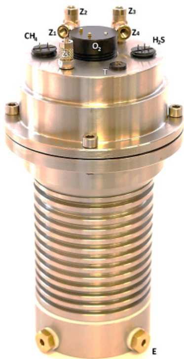
Rys. 1. Urządzenia do rozdrabniania skał z oznaczonymi czujnikami gazów
