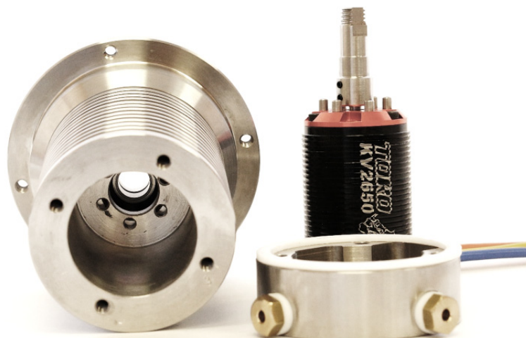
Rys. 2. Silnik wysokoobrotowy zastosowany w rozdrabniaczu do skał wraz z korpusem urządzenia
