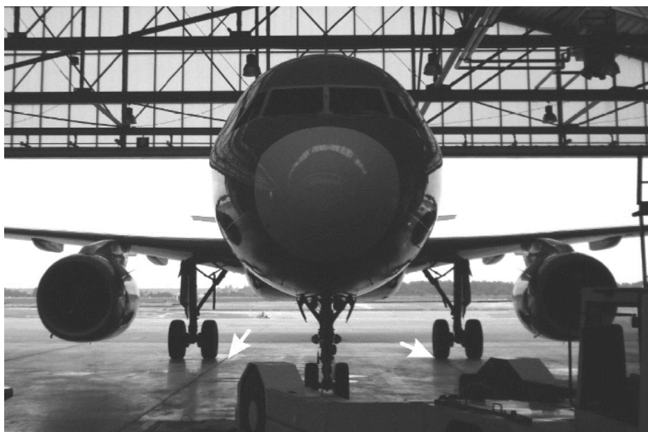
Rys. 11. Położenie kół goleni głównej serwisowanego samolotu typu Airbus A320 względem szczelin dylatacyjnych płyty P1 , wskazanych strzałkami
