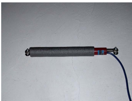
Rys. 7. Ekstensometr 4420 d zainstalowany na ścianie przy głównym wejściu
