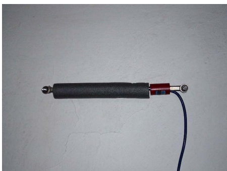
Rys. 6. Tensometr 4420 c zainstalowany na południowej ścianie
