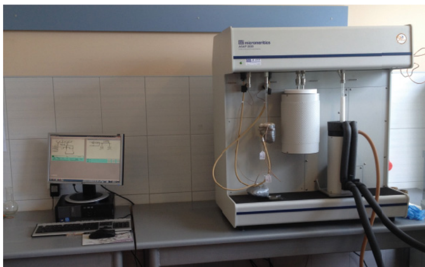
Rys. 1. Stanowisko niskociśnieniowej adsorpcji gazowej z analizatorem ASAP 2020
