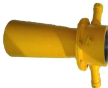
Rys. 4. Strumienica pneumatyczna typu HURAGAN 120
