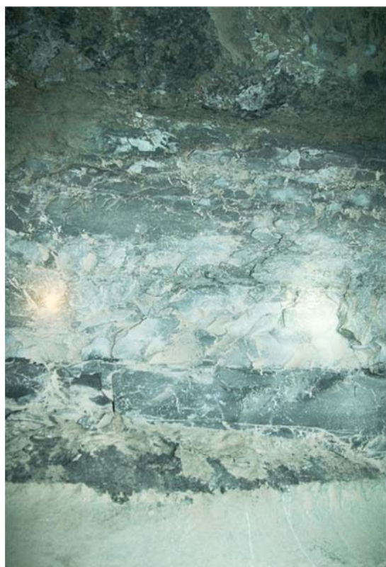
Rys. 3. Fragment ociosu chodnika w kopalni Rudna z widocznymi warstwami profilu skał miedzionośnych
