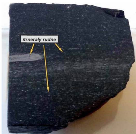
Fot. 11. Czarny łupek miedzionośny z widocznym okruszczeniem – zgląd makro
