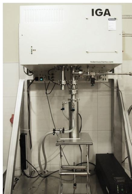
Rys. 7. Schemat ideowy i zdjęcie urządzenia grawimetrycznego IGA-001
