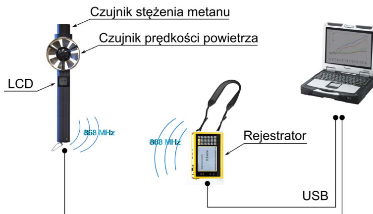
Rys. 1. Urządzenie do wyznaczania strumienia objętości metanu w wyrobisku kopalni
