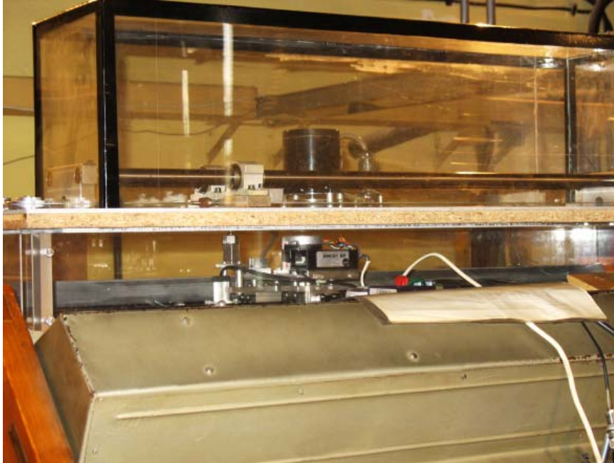
Fot. 1. Stanowisko do wzorcowania układu do pomiaru prędkości powietrza
