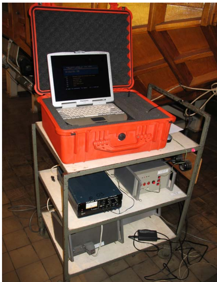
Fot. 3. Programowany układ sterujący ruchem karetki
