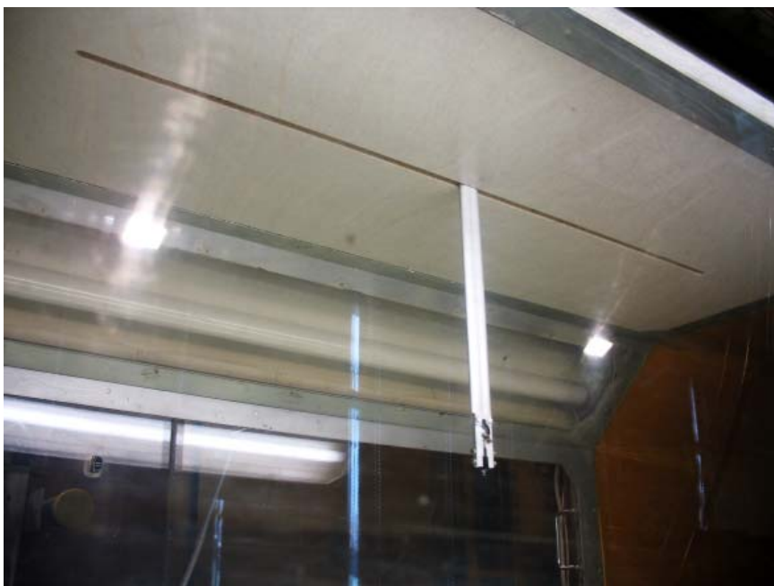
Fot. 2. Sonda termooanemometryczna w komorze pomiarowej tunelu
