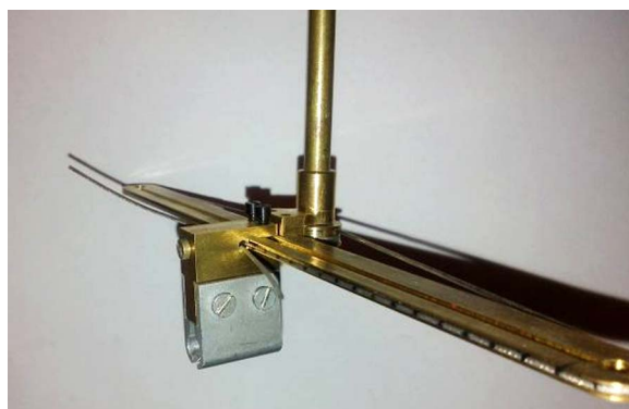
Rys. 3. Nowe mocowanie sondy pomiarowej
