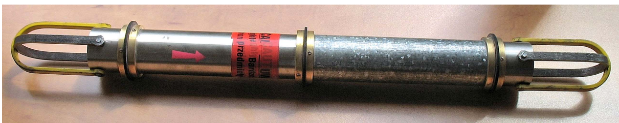
Rys. 7. Miernik natężenia strumienia gazu w otworach odmetanowania
