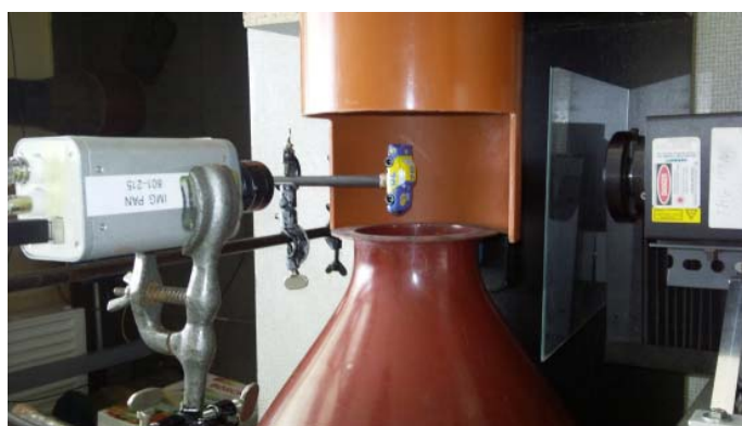
Fot. 2. Widok komory pomiarowej z zamontowanym modelem (z lewej strony widoczna jest kamera, a z prawej laser)
