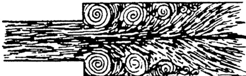
Rys. 1. Rysunek Leonarda da Vinci przedstawiający oderwanie i przepływ wsteczny w obszarze gwałtownego rozszerzenia rury
