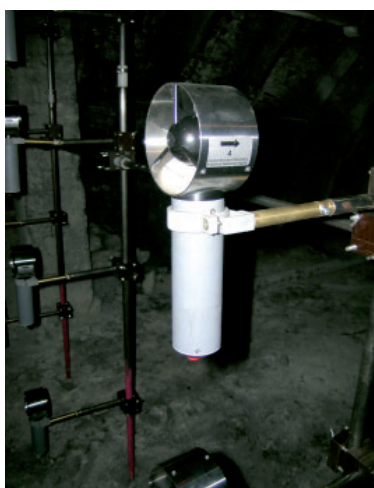
Rys. 2. Skrzydełkowy czujnik anemometryczny z radiową transmisją danych
