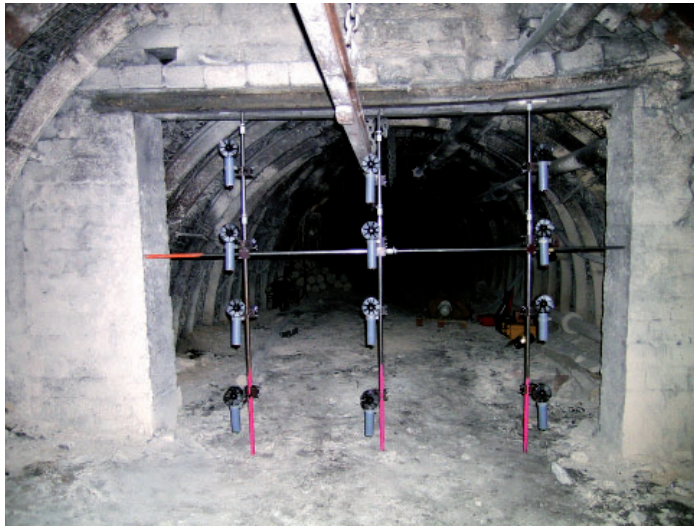
Rys. 12. Rozmieszczenie czujników w odrzwiach tamy bezpieczeństwa
