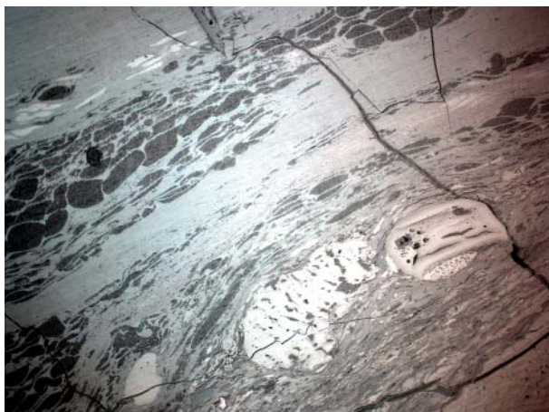
Fot. 1. Próbką R-1. Węgiel z rejonu uskoku. Fragment węgla, lekko spękany zbudowany jest z macerałów wityrynowych (kolinit) inetryrynowych (sklerotynit) i egzynyty (rezynit impregnujący wityryt). Światło odbite, immersja, pow. 320×
