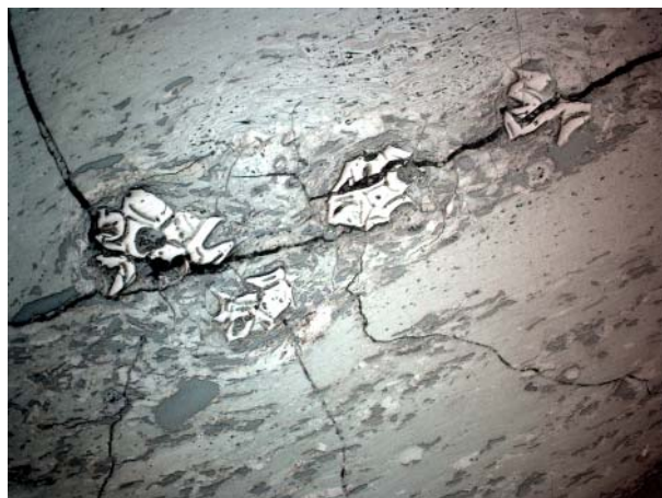
Fot. 2. Próbką R-1. Węgiel z rejonu uskoku. W centralnej części jaśniejsze fragmenty węgla to sklerotynit, pozostałą część wypełnia wityryt impregnowany przez rezynit. Światło odbite, immersja, pow. 320×
