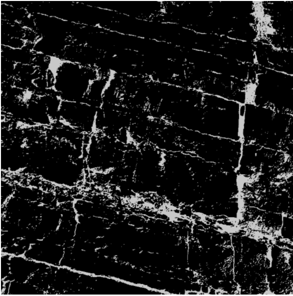
Rys. 3. Obraz będący wynikiem binaryzacji obrazu z rys. 2 przy wykorzystaniu metody k-means
