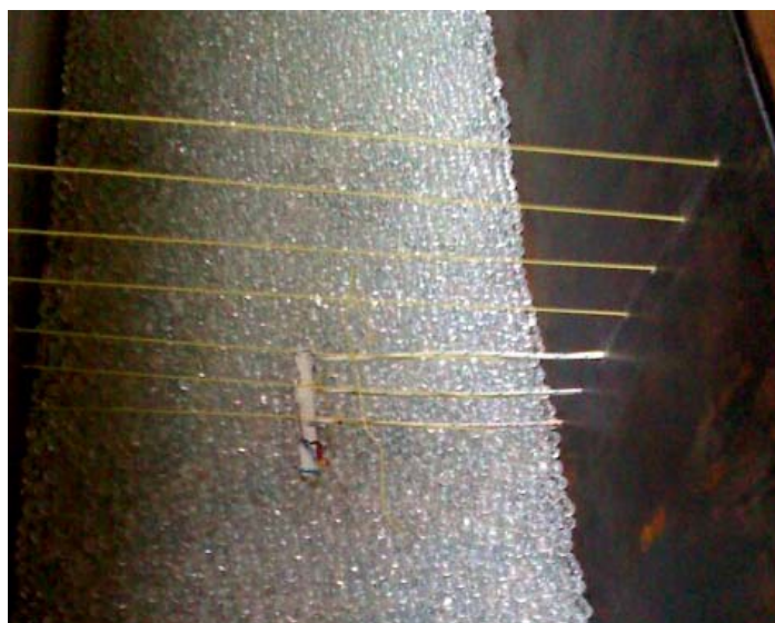
Rys. 8. Sposób mocowania termopar w złożu
