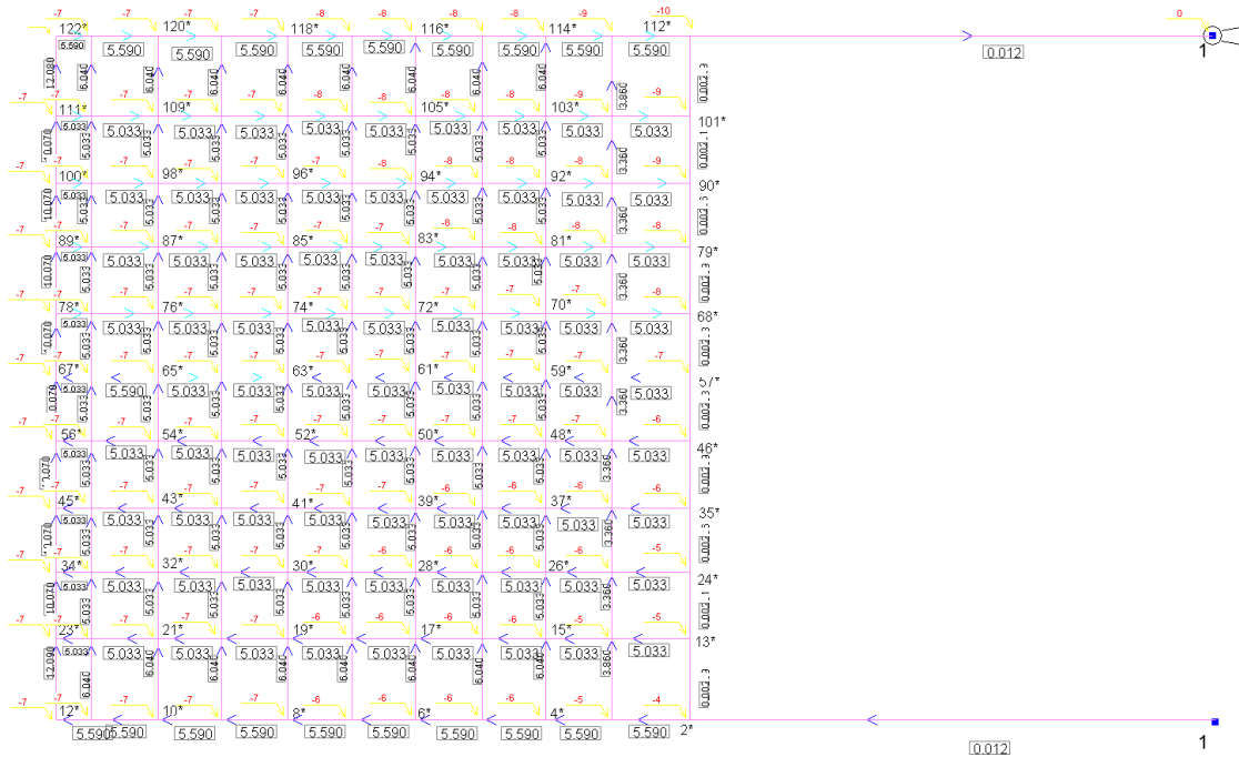
Rys. 11. Opory bocznic dla zrobów o jednorodnej przepuszczalności
