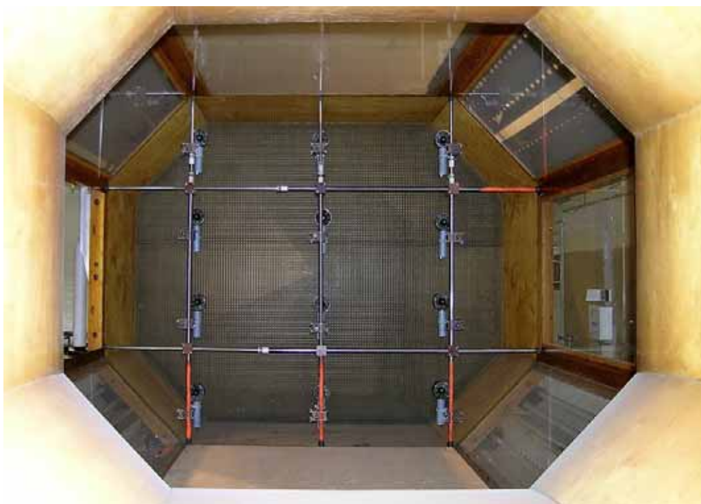
Rys. 23. System wielopunktowego pomiaru pola prędkości umieszczony w dużej komorze tunelu aerodynamicznego
