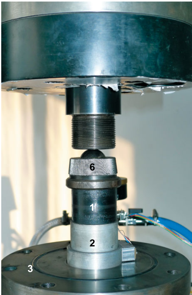
Rys. 3. Próbkę wraz z kulisą podczas testu jednoosiowego ściskania: 1 – próbka, 2 – dynamometr, 3 – dolna płyta komory, 6 – kulisa
