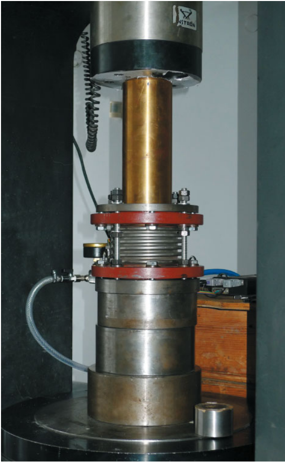
Rys. 6. Komora podczas ściskania w prasie INSTRON 8500 Rock Testing System
