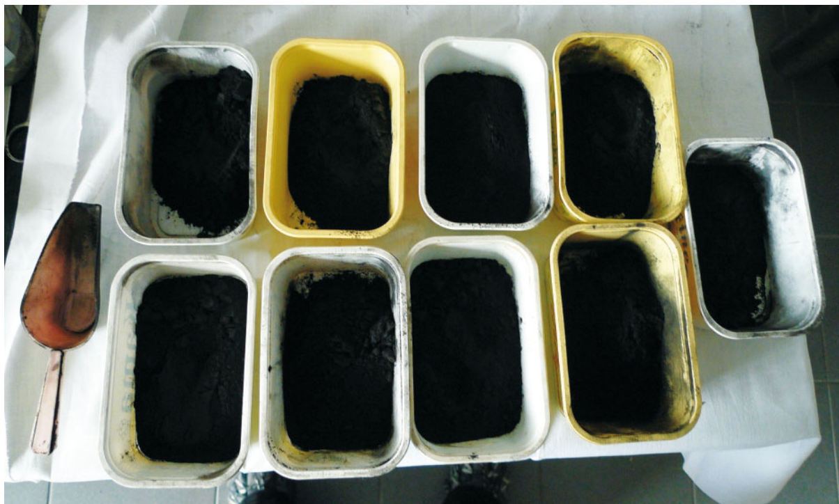
Rys. 1. Miał węglowy przygotowany do wykonywania brykietów
