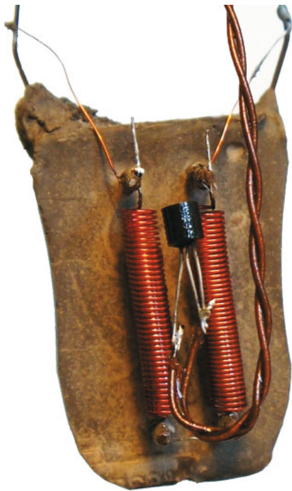
Rys. 5. Miedziane cewki czujnika zamocowane do odlewu gipsowego, widoczny również czarny czujnik temperatury
