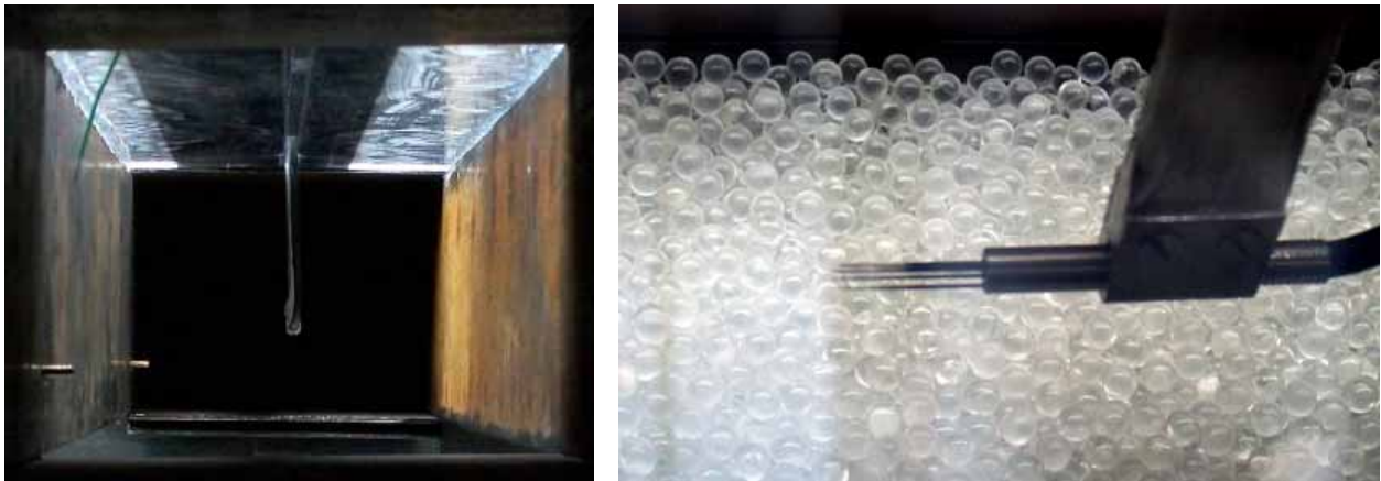
Rys. 5. Sonda w przestrzeni pomiarowej
