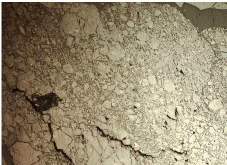
Rys. 1. Fragment węgla kataklastycznego (zdjęcie mikroskopowe – powiększenie optyczne 200×, światło odbite)
