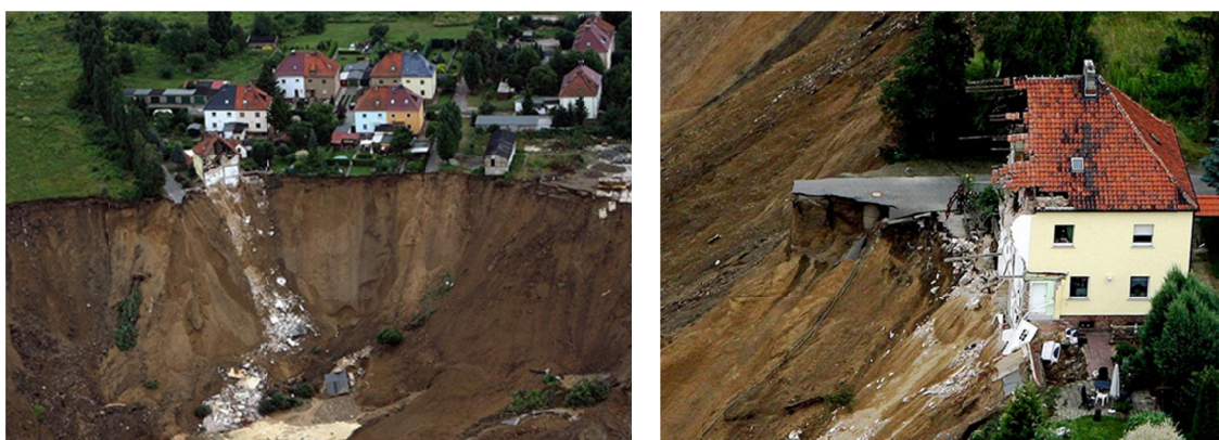
Rys. 9. Osuwisko powstałe w miejscowości Nachterstedt w pobliżu dawnej eksploatacji węgla brunatnego [10]
