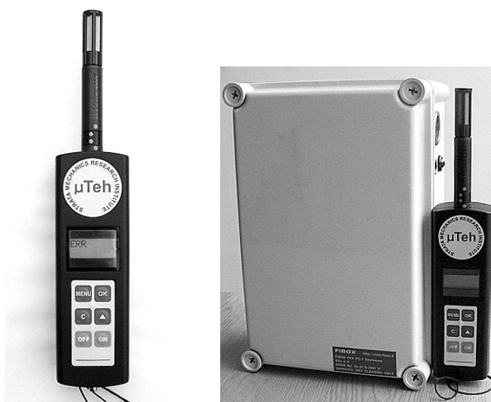
Fot. 1. Elementy systemu pomiarowego Datalogger \mu Tech z czujnikiem HygroClip i czujnik Setra 470
