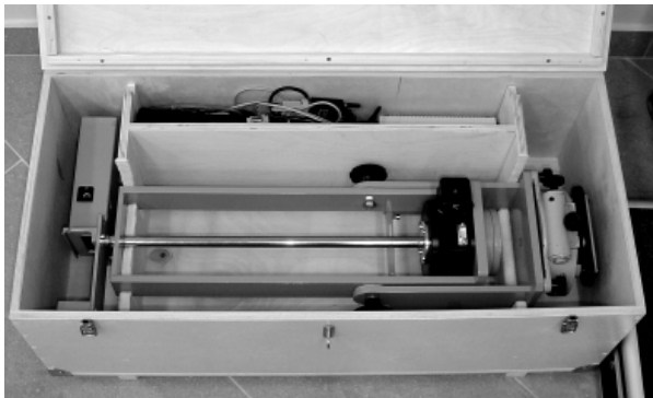
Rys. 7. Profilometr w skrzyni transportowej i skrzynia ze statywem
