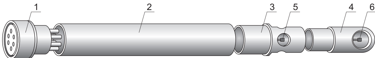
Rys. 4. Rysunek złożeniowy zintegrowanej sondy termoelementarnej w obudowie
