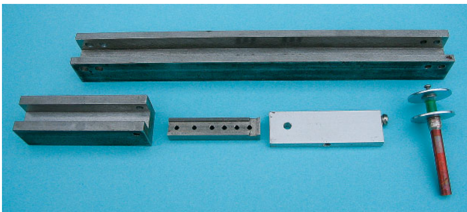
Rys. 2. Przyrządy do montażu tensometrów: szablony do wierceń, szpulka do nawijania cewek
