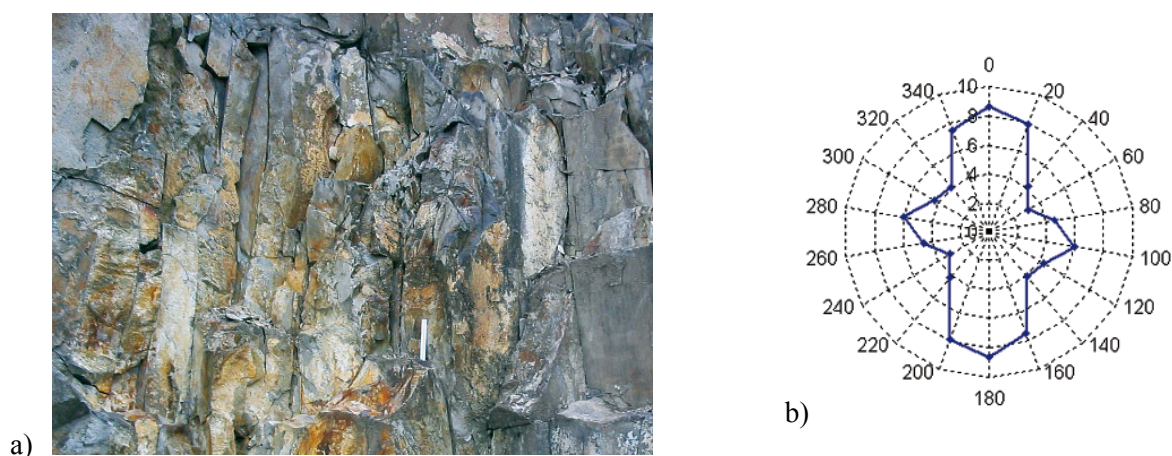
Rys. 3. Analizowana fragment ściany skalnej w kamieniołomie w Minkini oraz róża kierunków obserwowanych na niej nieciągłości
