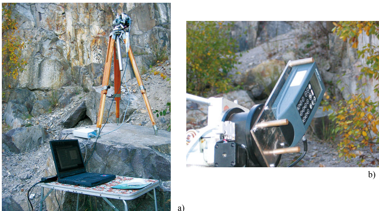
Rys. 9. Stoisko pomiarowe (a) oraz zbliżenie głowicy laserowej (b)
