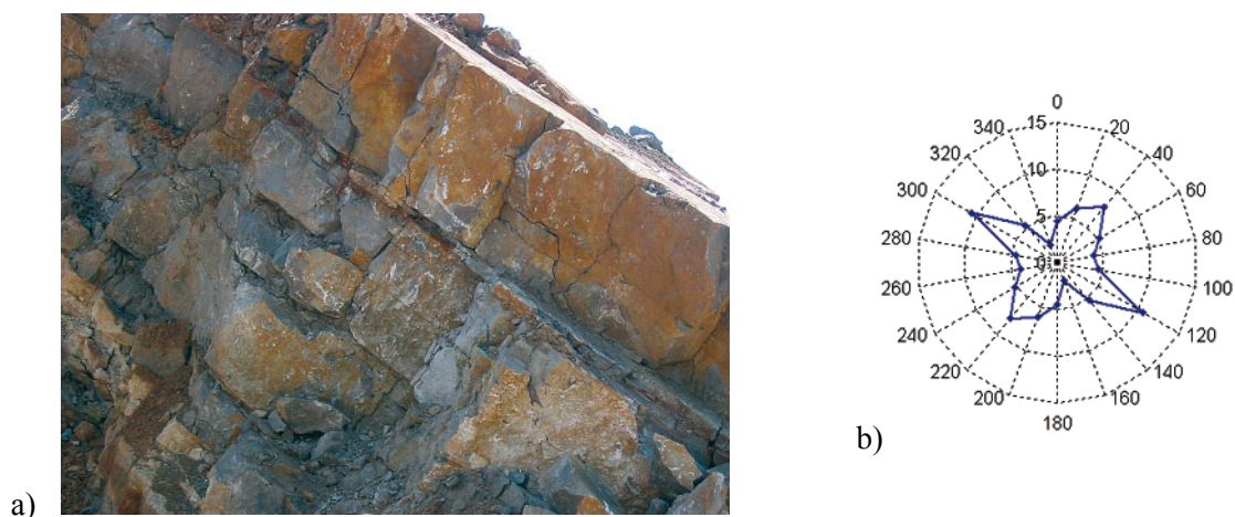
Rys. 5. Analizowana fragment ściany skalnej w kamieniołomie w Czatkowicach oraz róża kierunków obserwowanych na niej nieciągłości
