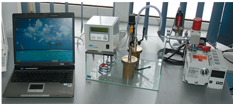
Rys. 10. Schemat oraz widok ogólny stanowiska do badań sorpcyjnych
