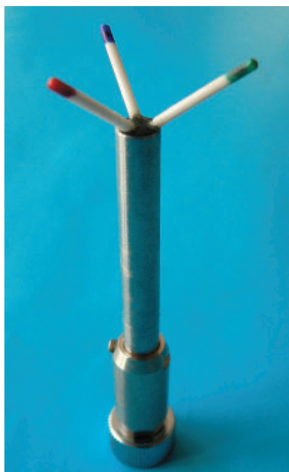
Fot. 1. Czujnik do wyznaczania składowych wektora prędkości w warunkach przemysłowych
