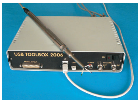
Fot. 3. Termoanemometryczny system wyznaczania składowych wektora prędkości przepływu
