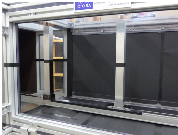
Rys. 1. Pręty zamontowane na posuwie liniowym w komorze pomiarowej
