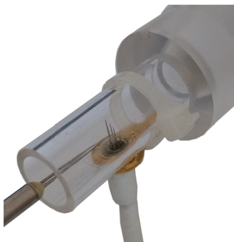
Rys. 6. Sposób umieszczenia pojedynczej sondy w opracowanym spirometrze do pomiaru zmian pola temperaturowego za grzanym włóknem
