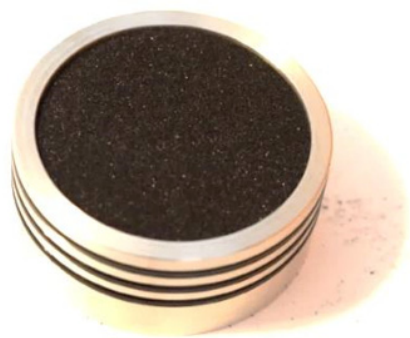
Rys. 4. Ziarnista próbka węgla umieszczana w zbiorniku na próbkę sorpcjomatu manometrycznego
