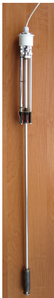
Rys. 3. Układ mechaniczny inklinometru fotoelektrycznego
