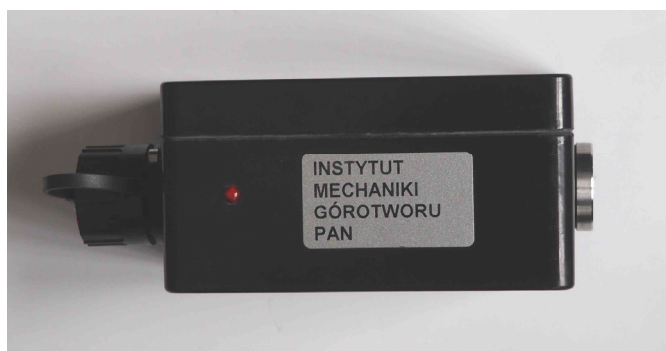
Fot. 3. Moduł pomiarowy stężenia metanu lub tlenku węgla
