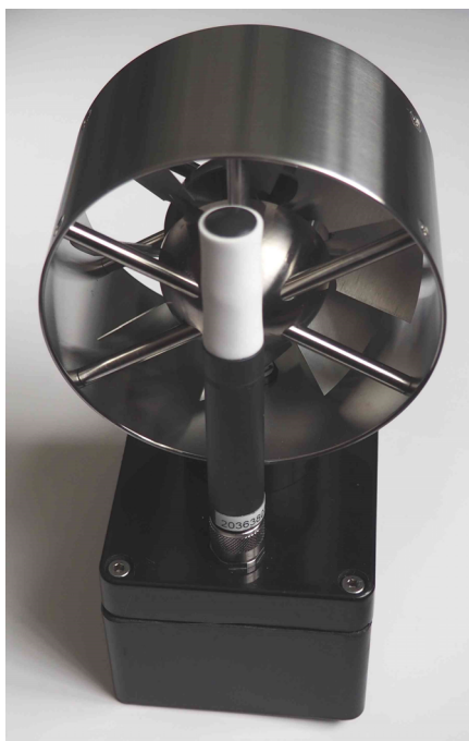
Fot. 4. Moduł pomiarowy w wersji przeznaczony dla przemysłu powierzchniowego i obiektów budowlanych
