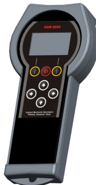
Rys. 2. Widok rejestratora urządzenia do pomiaru stężenia metanu i prędkości przepływu
