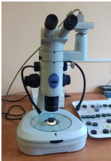
Rys. 1. Mikroskop stereoskopowy Nikon SMZ 1500
