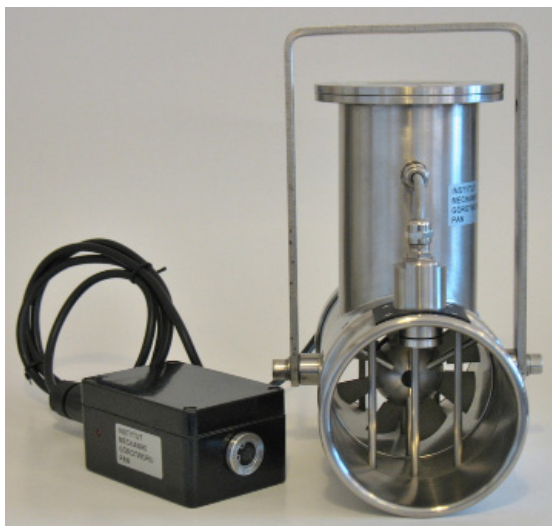
Fot. 1. Metanoanemometr stacyjny MPM. Główny zespół pomiarowy i moduł dodatkowego czujnika stężenia metanu
