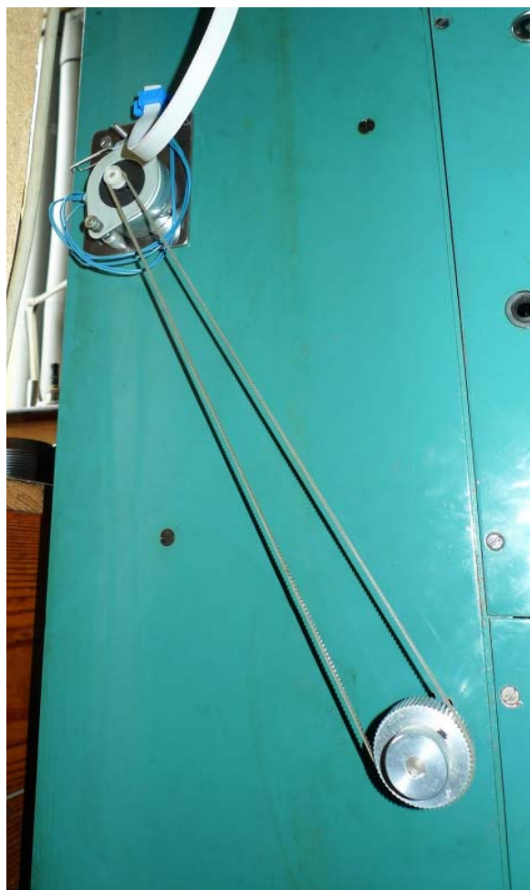
Rys. 1. Układ wykonawczy automatyki prasy; u góry z lewej silnik krokowy, u dołu z prawej pokrętło regulujące wydatek pompy sprzężone paskiem z silnikiem
