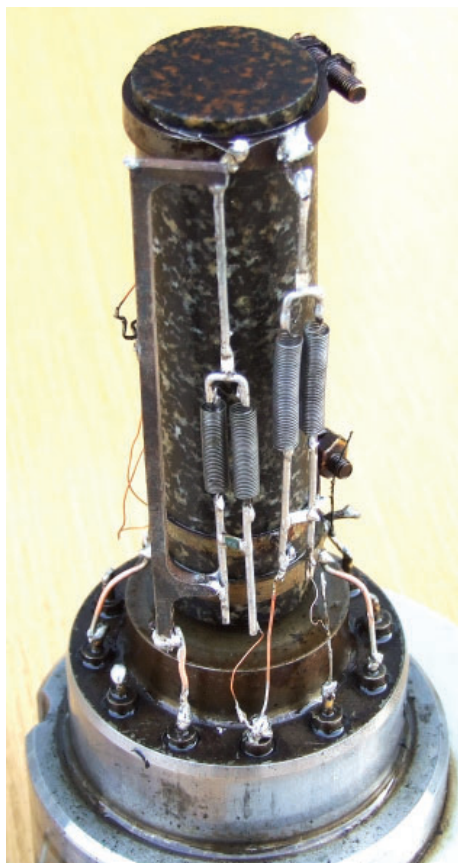
Rys. 1. Czujnik pomiarowy w układzie równoległym (po prawej), oraz – czujnik odniesienia zamocowany na stalowym wsporniku (po lewej)
