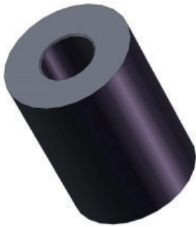
Rys. 2. Rura ze stali w której umieszczana jest uformowana próbka węgla
