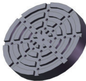
Rys. 5. Końcówki tłoków rozprowadzające gaz po powierzchniach czołowych próbki
