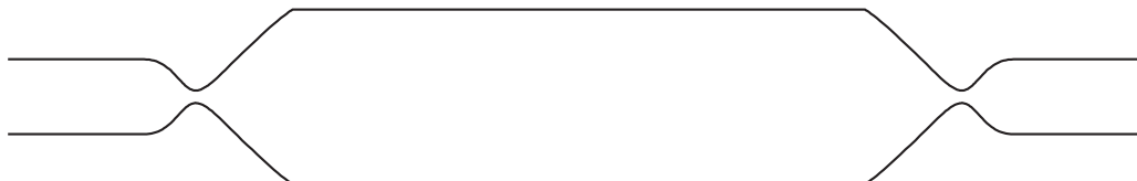
Rys. 4. Model szczeliny jako sekwencji składającej się z trzech zasadniczych elementów: elementu zasadniczego obejmującego niemal całą długość szczeliny, hiperbolicznego obszaru styku z szczeliną sąsiednią oraz obszaru przejściowego między obszarem zasadniczym a hiperbolicznym obszarem styku
